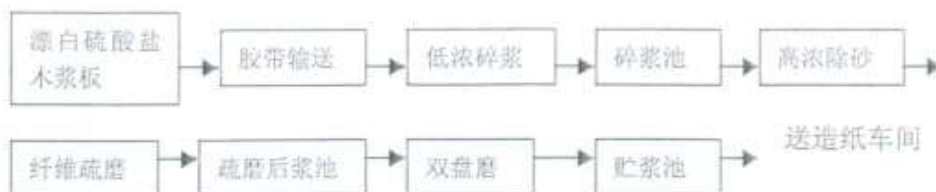
图 2.2-4 打浆工艺流程图
