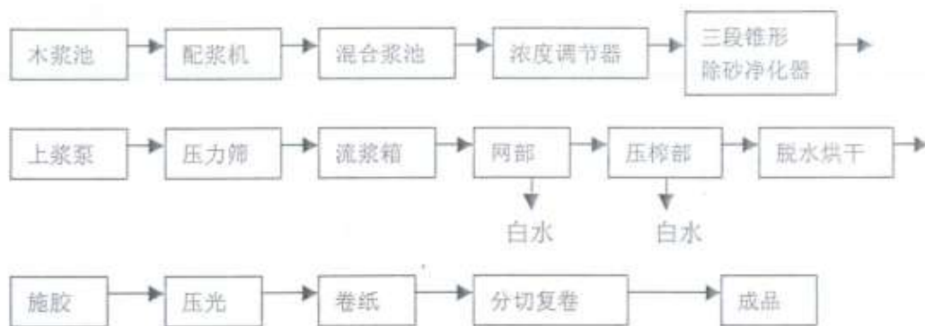
图 2.2-5 抄纸工艺流程图
